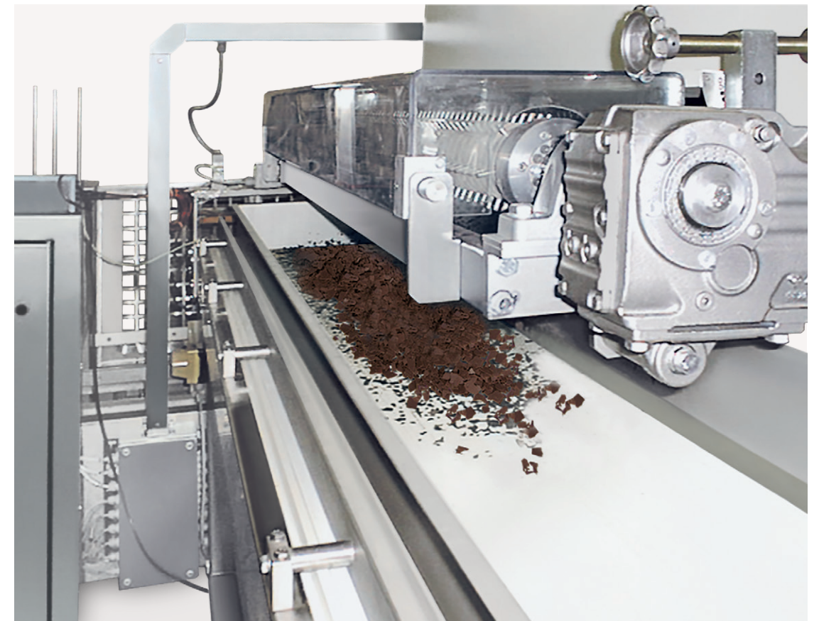
Brechstation zum Brechen von Schokoladenflakes mit anschließendem Quertransport Breaking device for breaking-up into chocolate flakes followed by a cross conveyor
