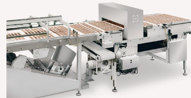
Die Abbildung zeigt einen „Buncher“, mit dem auch kleine Produkte in geordneten Gruppen zusammengeführt werden können; wahlweise kann auch ein Metallsuchgerät aufgesetzt werden
