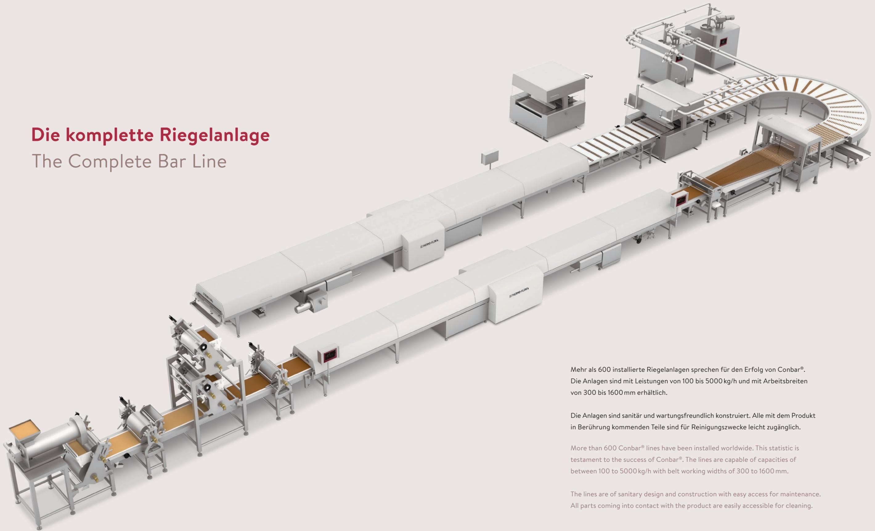
Mehr als 600 installierte Riegelanlagen sprechen für den Erfolg von Conbar®. Die Anlagen sind mit Leistungen von 100 bis 5000 kg/h und mit Arbeitsbreiten von 300 bis 1600 mm erhältlich.
