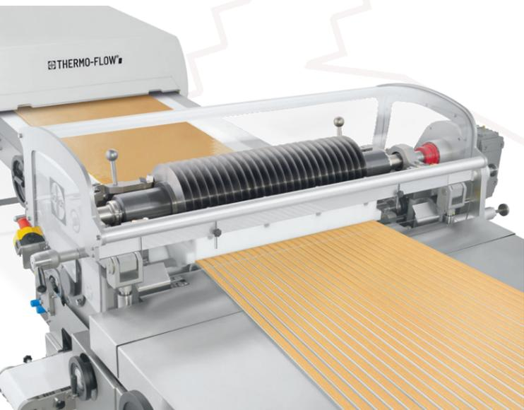
Rundmesser mit variabler Drehzahl speziell für Riegel aus Zucker- oder Cerealienmassen
