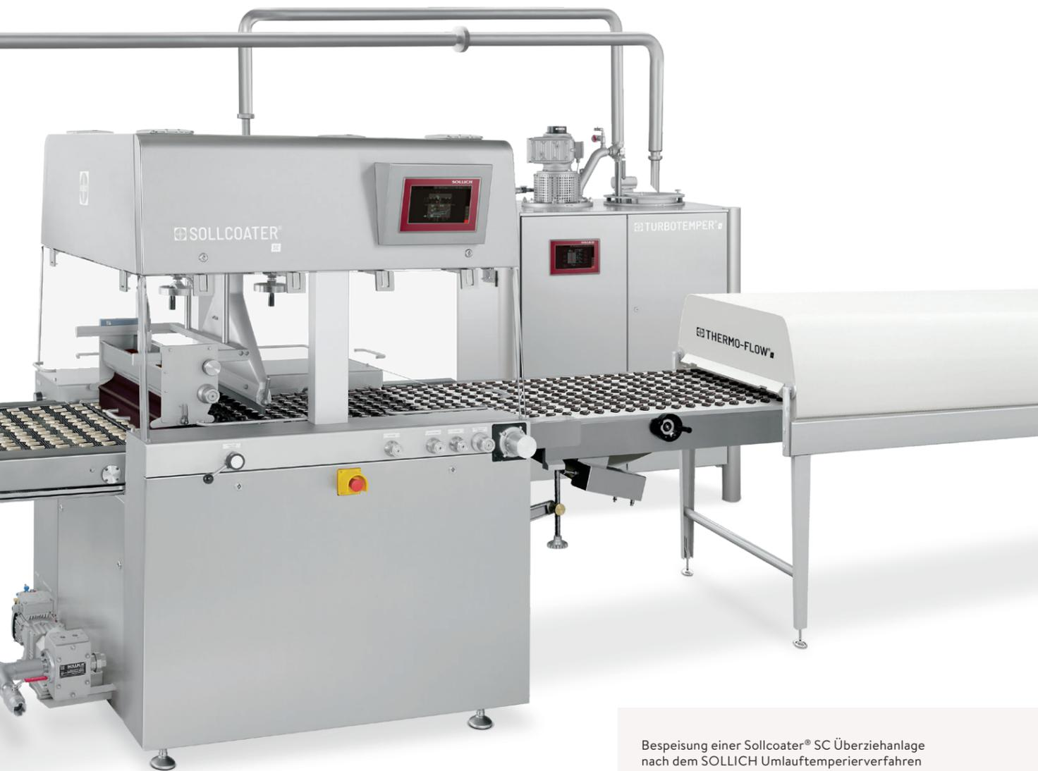
Bespeisung einer Sollcoater® SC Überziehanlage nach dem SOLLICH Umlauftemperierverfahren
