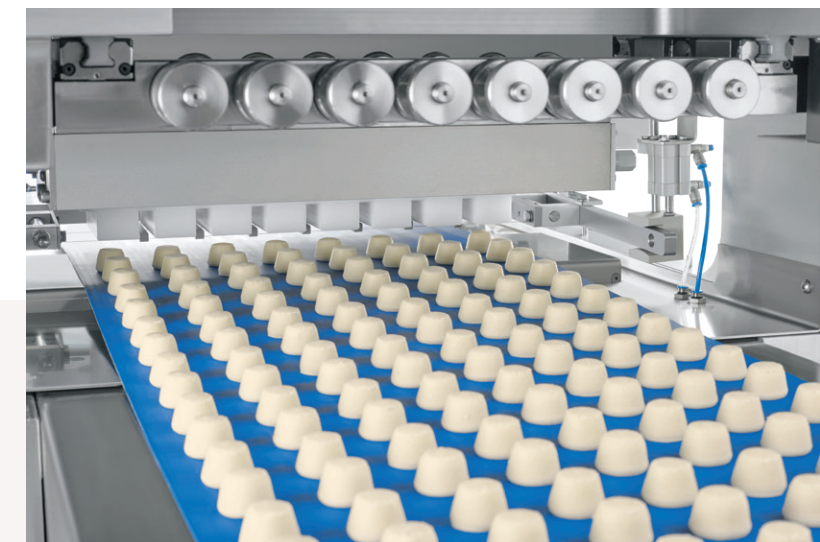
Sollformat® mit automatischem Drahtschneider zur Pralinenherstellung Sollformat® with automatic wire cutter for confectionery centers
