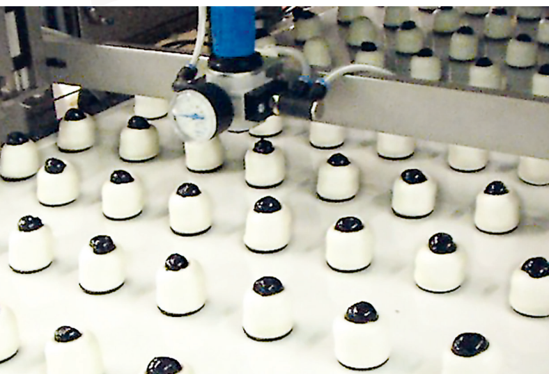
Jeweils eine Kirsche wird gezielt auf einen Schaumartikel aufgelegt Precise depositing of a cherry onto an angel kiss product
