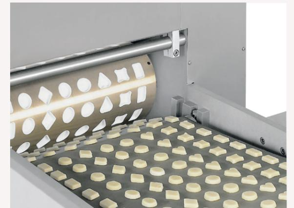
Durch den einfachen Wechsel der Formwalze ist der Umstieg auf andere Produktformen oder -massen in kurzer Zeit möglich
